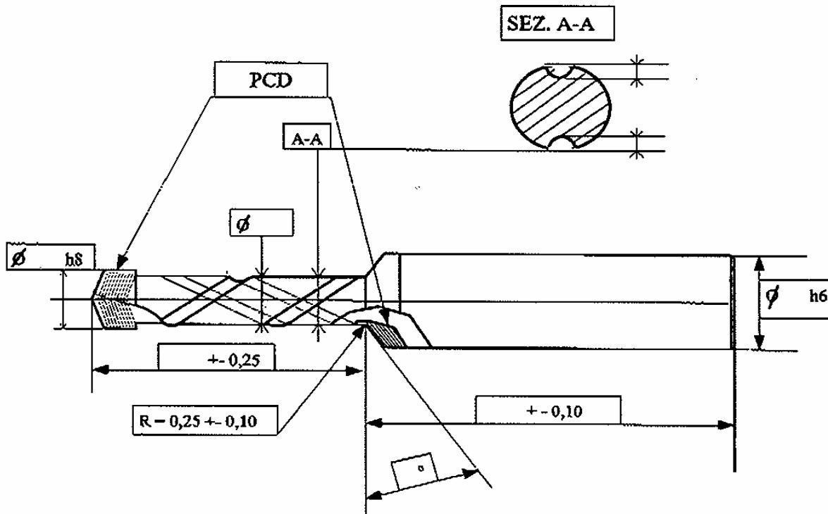
Punta elica in M.D " " con fori di refrigerazione , elica a °
