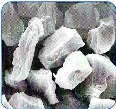
I granuli di tipo aghiforme o fogliare riducono l'efficacia del materiale superabrasivo.
